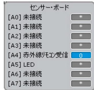
【2】ロボットの赤外線リモコン受信センサーにお手持ちのリモコンをかざして、登録したいリモコンのボタンを押してください。[A4] 赤外線リモコン受信の欄に各ボタンに対応した番号が表示されます。
